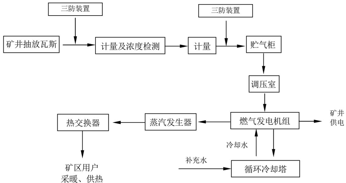
图 13—1 矿井瓦斯发电工艺流程图
