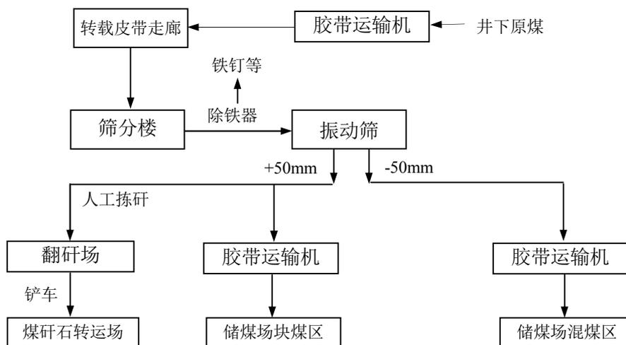
图 2—9 地面生产系统工艺流程
